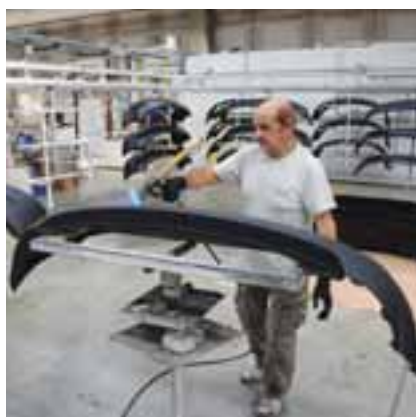
Nahřívání nárazníku před lakováním
