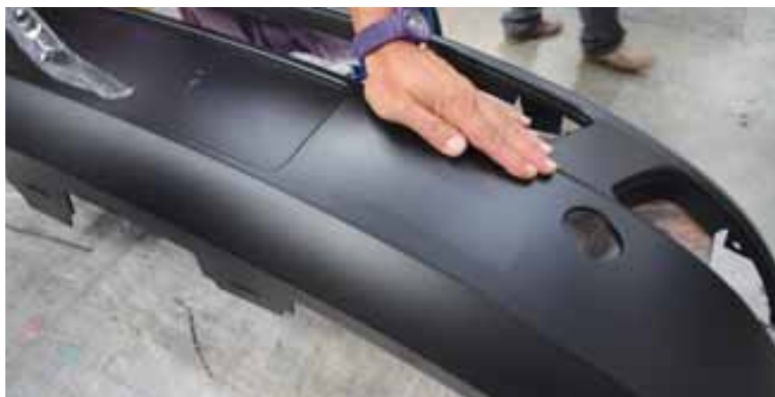
Test kvality primeru lepicí páskou
